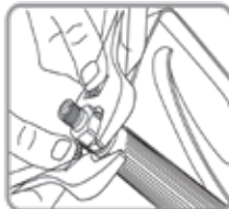
14. Desenrosca a porca atrás do conector giratório.
