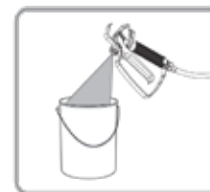
8. Pulverizar la pintura en el cubo de residuos.
