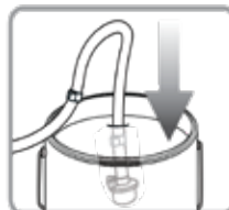
4. Tubo de sucção em água ou fluido de lavagem.
