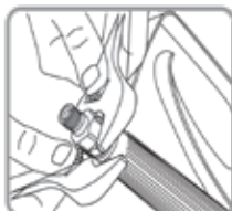
14. Desenrosque la tuerca detrás del conector giratorio.
