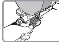
3. Gire el botón de pulverización a la posición de pulverización.
