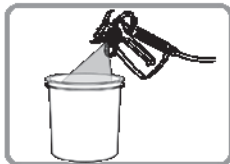
5. Pulverizar en el cubo de residuos hasta que desaparezca el atasco.
