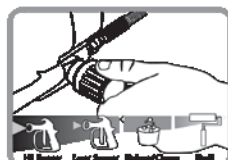
5. Réglez le bouton de contrôle de la pression sur Amorçage/Nettoyage.
