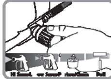
2. Ajustar el mando de control de la presión a la posición más baja, y luego aumentar según sea necesario.
