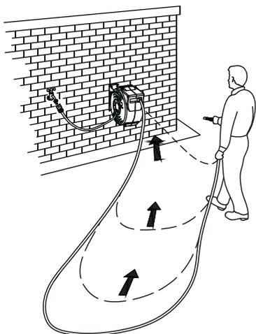
2. A catraca de travamento automático manterá a mangueira no lugar no comprimento desejado. A função de travagem da mangueira pode ser notada pelo som de clique.
