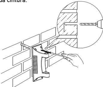
2. Tendo o suporte como modelo, marque a localiza o dos parafusos. Fa a os 4 furos e insira as buchas, antes de alinhar o suporte e fixar com os 4 parafusos.
