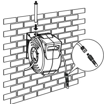
4. Instale as ligações na torneira e ligue a mangueira de 2 mt usando a ligação rápida. Teste para garantir que a bobine gira livremente em 180 com a torneira ligada ao enrolador.
