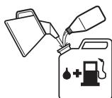
Realizar la mezcla con 95 RON sin plomo con aceite sintético especial de 2 tiempos en la proporción del 3.33% (una porción de petróleo para 30 partes de la gasolina).
