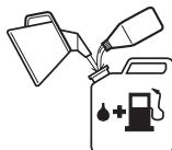
Realize a mistura com 95 RON sem chumbo com óleo sintético especial de 2 tempos na proporção de 3.33% (uma parcela de petróleo para 30 partes da gasolina).
